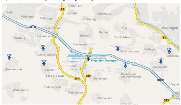
Lage der Außenmessstellen der Fluglärmmessanlage des Flughafens Stuttgart
