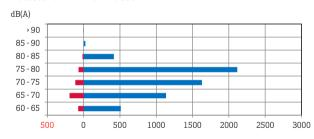
Anzahl (N1) der korrelierten Lärmereignisse (Tag+Nacht) mit Lmax > 60 dB(A): 6301 Gesamtzahl der Flugspuren (N2) im 2 km Umkreis der Messstelle: 8896
